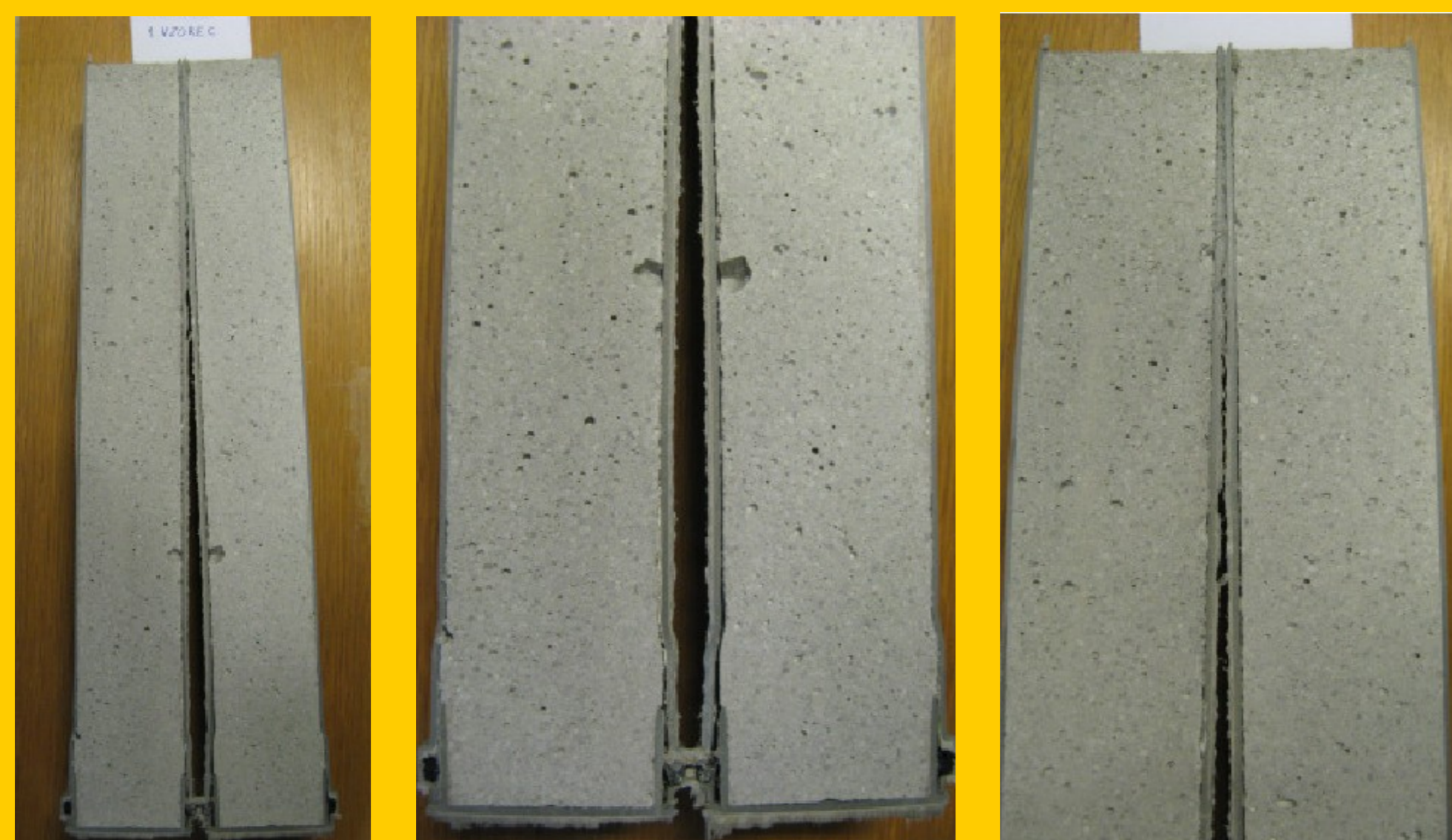
Prerez homogenega vzorca, 28 dni po vgraditvi
