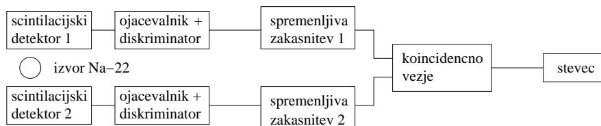
Slika 7: Sistem za merjenje koincidenčnih dogodkov
