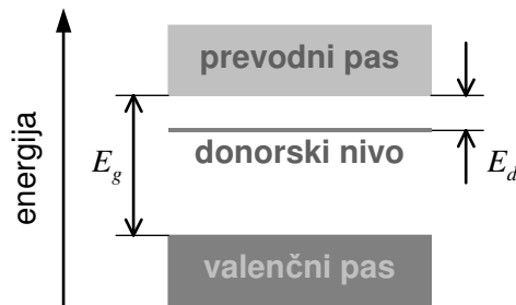
Slika 3. Valenčni in prevodni pas v polprevodniku tipa n. Donorski nivo leži tik pod dnom prevodnega pasu. Zato je dovolj že majhna energija E_d , da elektron iz donorskega nivoja preide v prevodni pas.
